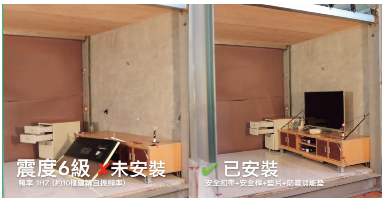
模擬在10樓、震度6級，有、無防護措施差異比較 右圖電視機以鐵線固定於電視櫃，電視櫃和文書櫃均以固定帶與牆壁連結防護
