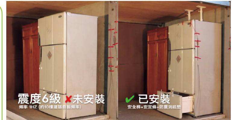
模擬在10樓、震度6級，有、無防護措施差異比較 右圖冰箱以伸縮桿支撐、衣櫃以防震消能墊防護
