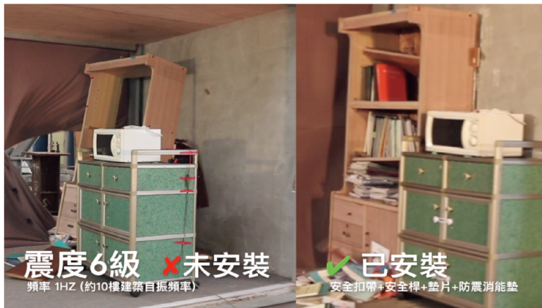
模擬在10樓、震度6級，有、無防護措施差異比較 右圖書櫃及矮櫃均以防震消能墊黏貼於牆壁防護
